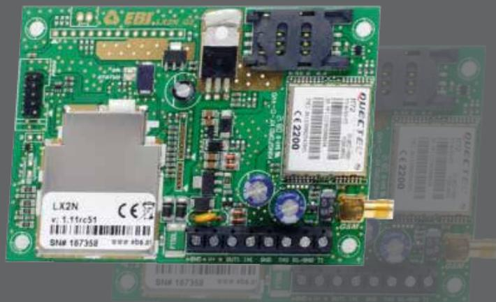
El **LX2NB** es un transmisor universal que usa el canal de datos GPRS de la telefonía celular para enviar eventos de alarma a centros de monitoreo. El **LX2NB** es compatible con cualquier panel de alarma que disponga de un comunicador telefónico en formato Contact ID.
